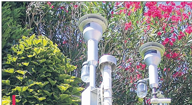
Des capteurs implantés dans toute la région permettent de mesurer plus de 80 polluants.
