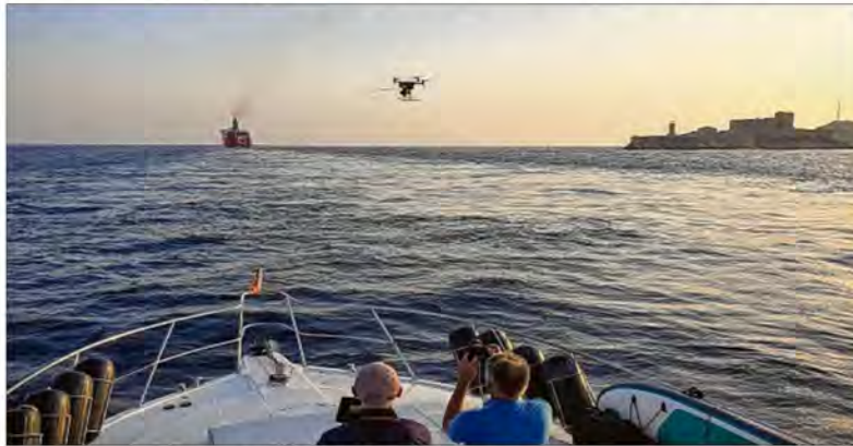
Atmosud a testé l'utilisation de drones pour mesurer les taux de soufre dégagés par les navires.
